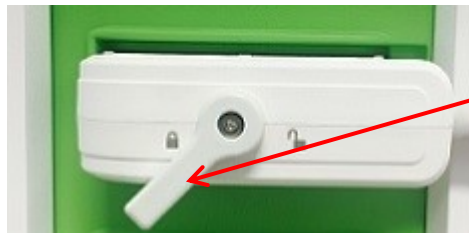
Kuva 28: Anturin liittimen asento
