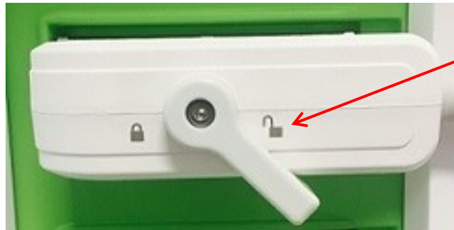
Kuva 29: Avattu anturin liittimen lukitussäädin avattuna
